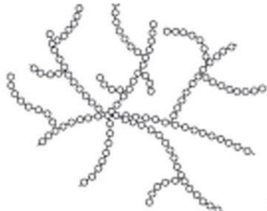
V amorfnih polimerih se dolge veržne molekule prepletajo brez reda.
